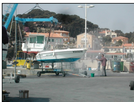
Illustration 1 : Nettoyage de la coque à l'aide d'un nettoyeur à haute pression (Source : Cetmef, 2005)
